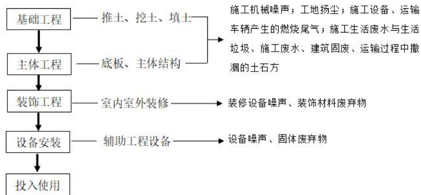
图 2-10 项目施工期工艺图
